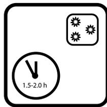
Не подвергать обработанную поверхность механическому воздействию 1,5 - 2 часа. Защитный слой полностью готов через 12 часов.
